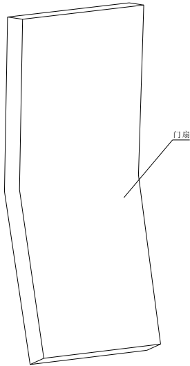
图11 门扇高度方向弯曲度示意图
