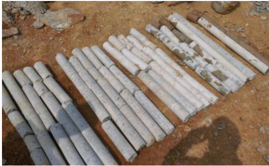
核心科教区项目桩基抽芯检测 (2016.3.7)
